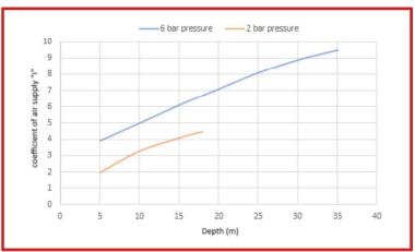
Variazione di portata in funzione della proforndità d'esercizio. Dati rilevati con un carico idraulico di 2 m e una pressione di alimentazione aria di 6 bar
