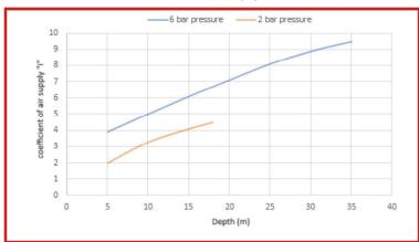
Variazione di portata in funzione della proforndità d'esercizio. Dati rilevati con un carico idraulico di 2 m e una pressione di alimentazione aria di 6 bar
